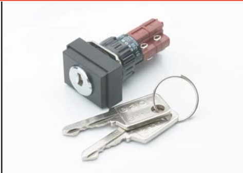
Commutador a llave, 2 posiciones, saliente, ruptura brusca, rectangular, plástico negro, 18 x 24mm
