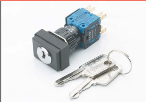
Commutador a llave, 3 posiciones, saliente, ruptura brusca, rectangular, plástico negro, 18 x 24mm
