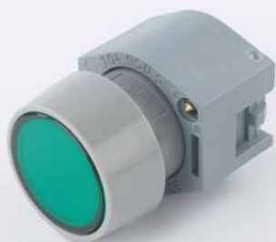
Pulsador saliente sin iluminación, aro frontal plástico gris, montaje 22,5mm
